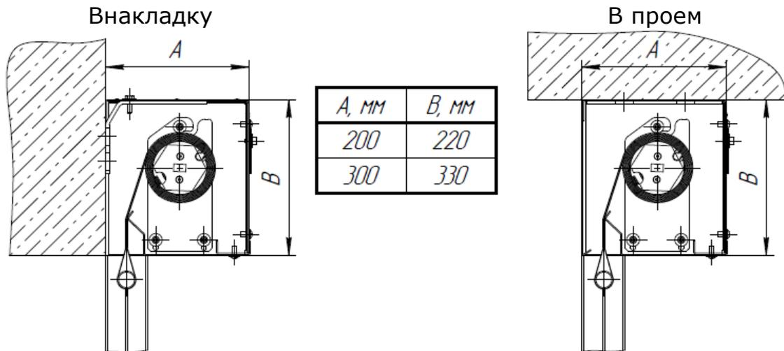
Варианты монтажа короба противопожарной шторы Fireshield EI-60:
